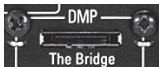
Abbildung 2 - Der DMP/The Bridge-Anschluss auf der Rückseite eines The Bridge Ready Produkts von Harman Kardon
